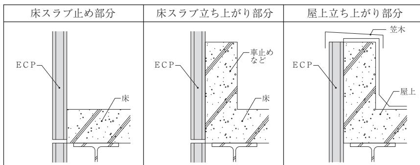
これらの部分でコンクリート型枠として使用すると、横張り工法ではECP長手または短手のクラック発生が考えられ、縦張り工法では大地震の際に留め付け部のクラックが予測されます。
