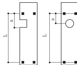
(5) 計算による安全確認に加え、孔あけ及び欠き込みの限度は、右表の数値以下とします。なお、パネルには設備機器を直接とりつけないでください。
