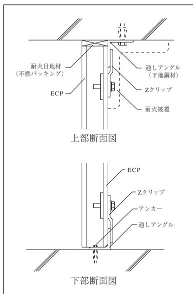
また、間仕切壁耐火構造認定書「別添」でも、上部の露出下地鋼材には耐火被覆の記載があり、下部の下地鋼材は露出していても耐火被覆の記載が無いことから、同様の判断ができます。
