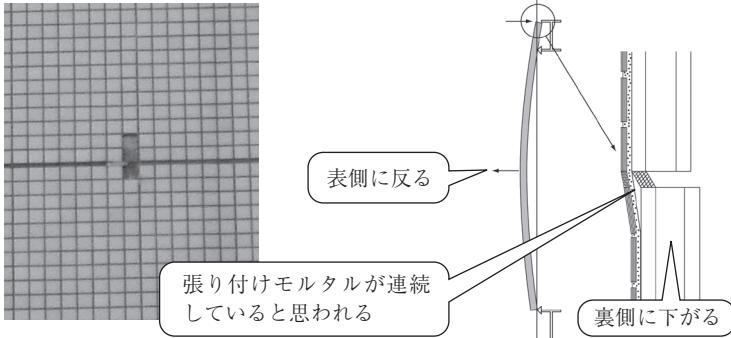
ECPへのタイル張り仕上げに使用できるタイルは、モルタル張りの場合は厚みが20mm以下のタイル、弾性接着剤張りの場合は厚みが10mm以下のタイルを目安にしています。試し張りを行い、確認してください。なお、工場タイル張りの場合は、上記に加えてタイル種類（凹凸のあるタイルや特殊面状タイルなど）と目地材に制限がありますので、製造メーカーにお問い合わせください。
