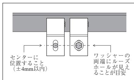
④ Zクリップは、ECPの中空に平行に付けてください。下地鋼材が斜めであっても、下地鋼材に直角に付けるのではなく、あくまで中空に平行にしてください。誤差（傾き）は、1／10（約6度）以内とします。
