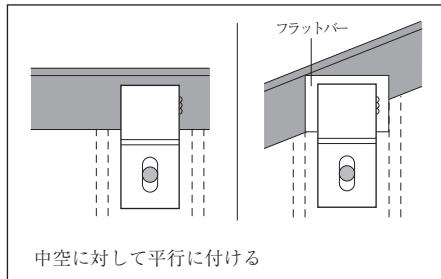
⑤下地鋼材へは、30mm以上掛けしてください。また、上向きと横向きのZクリップは、回転防止のために15mm以上下地鋼材に溶接してください。
