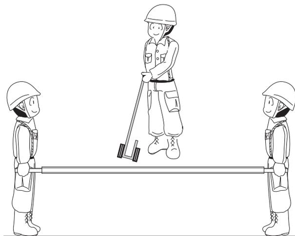
U型二輪車など小運搬用工具を選び、必ずもう一人がセットする。
