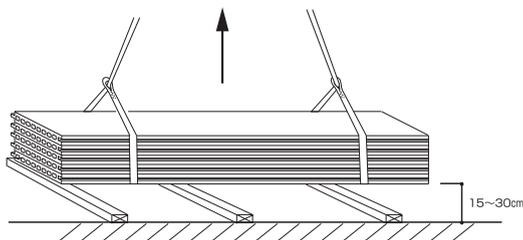
専用パレットにECPをのせ、スリングを掛けかえる
