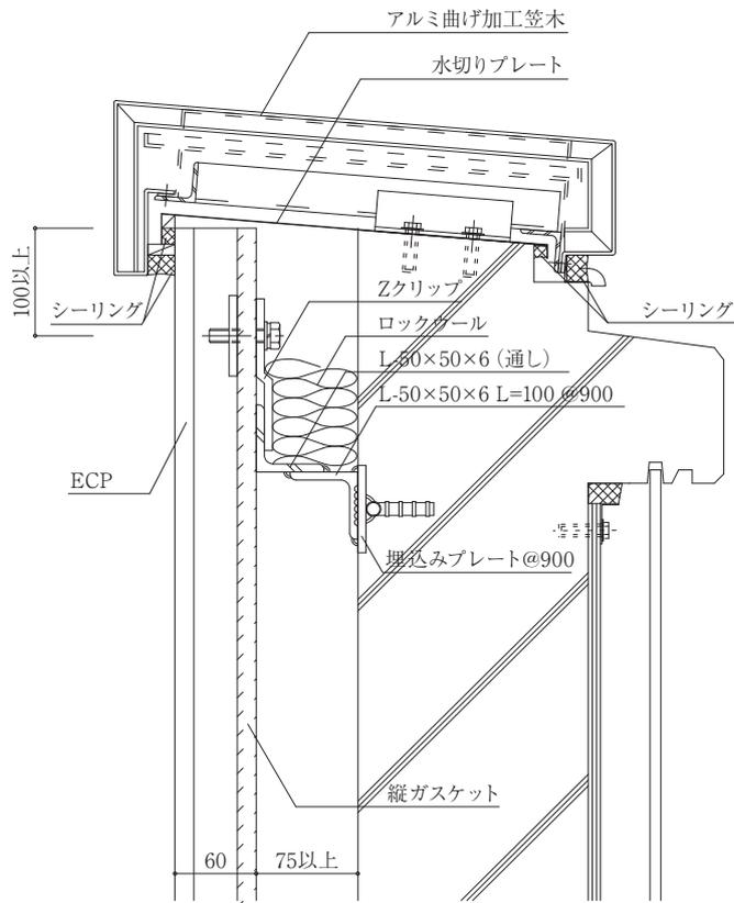
4-16 開口部垂直・水平断面詳細図
