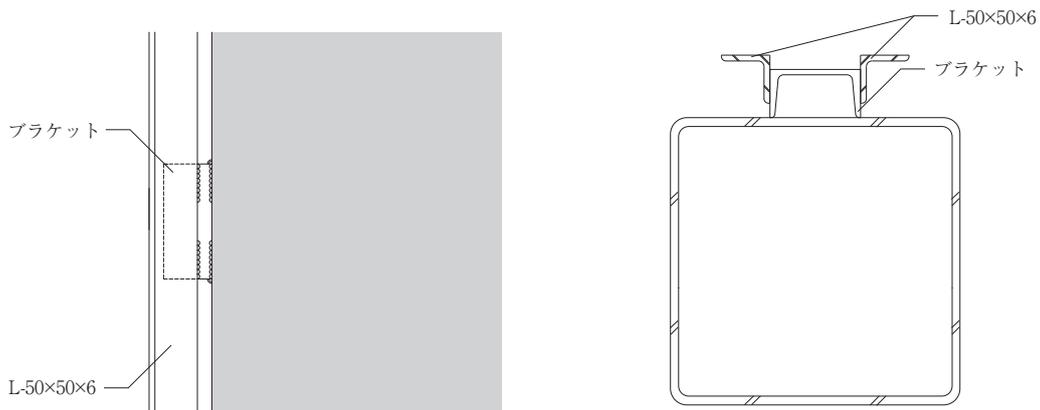
図5-14 横張り工法中間部下地鋼材取付け状況
