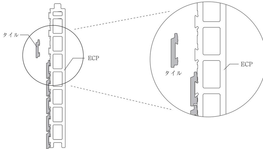
図8-4 乾式タイルパネル断面図
