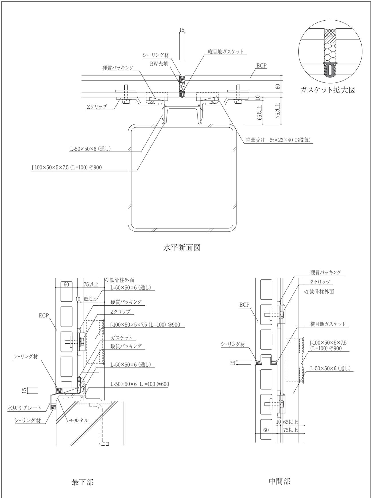
※下地鋼材を躯体鉄骨に直接溶接しない仕様の建物は、捨てプレートに躯体鉄骨に工場溶接し、これに下地鋼材を溶接する。
