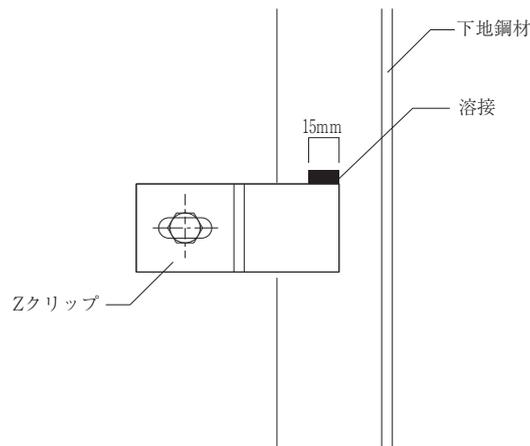
図5-13 Zクリップの取付け(横張り)
