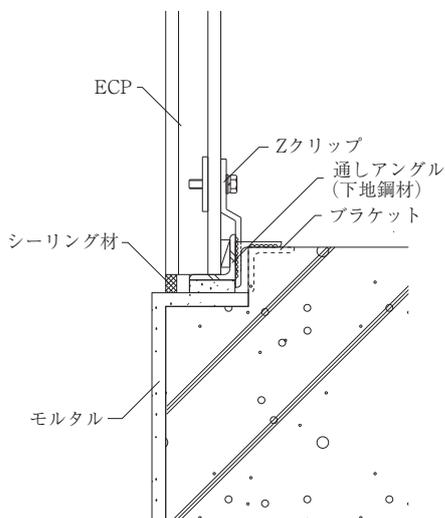
図5-5 縦張り工法下部標準詳細図
