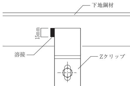
図5-12 Zクリップの取付け（縦張り）
