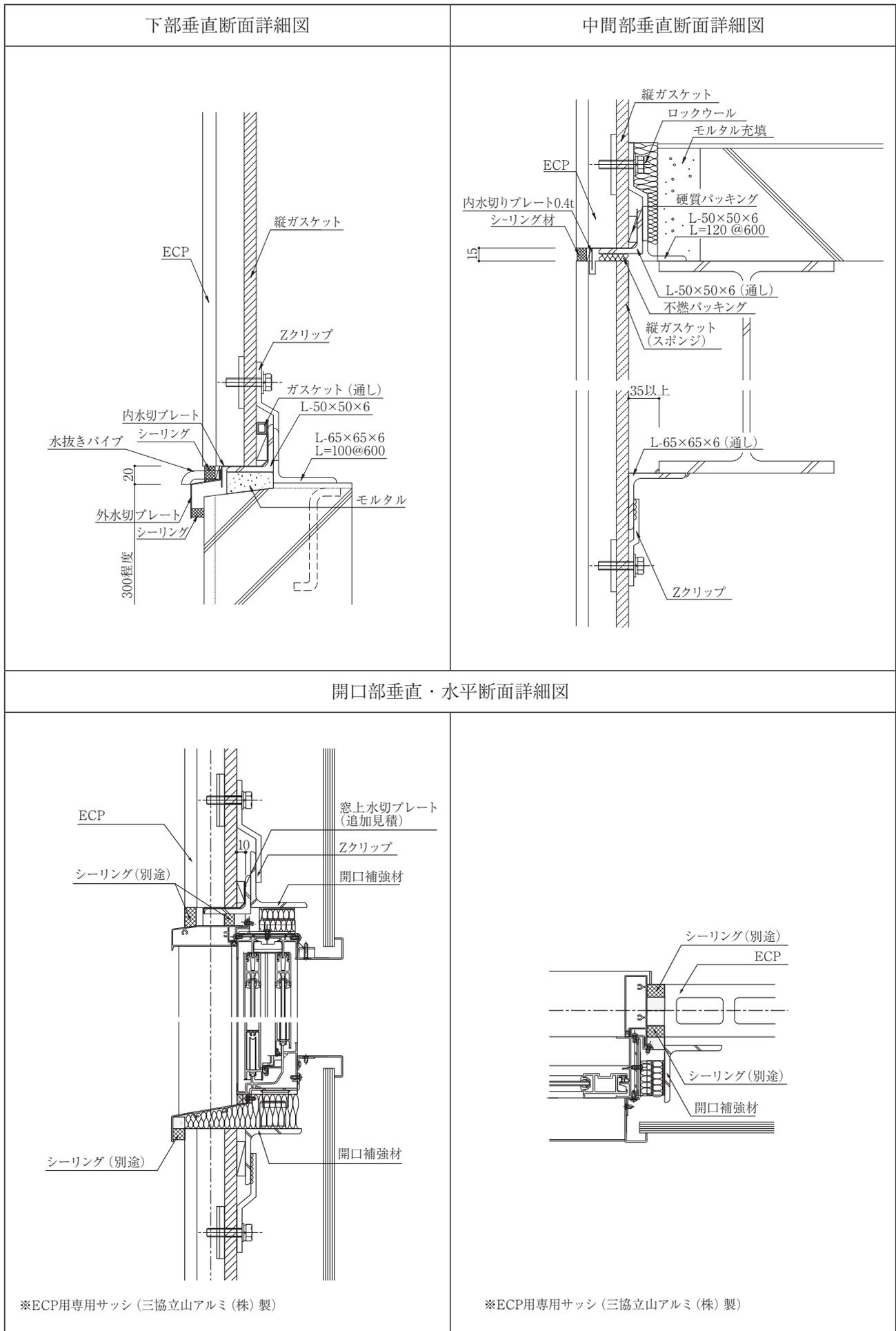
※下地鋼材を躯体鉄骨に直接溶接しない仕様の建物は、捨てプレート躯体鉄骨に工場溶接し、これに下地鋼材を溶接する。
