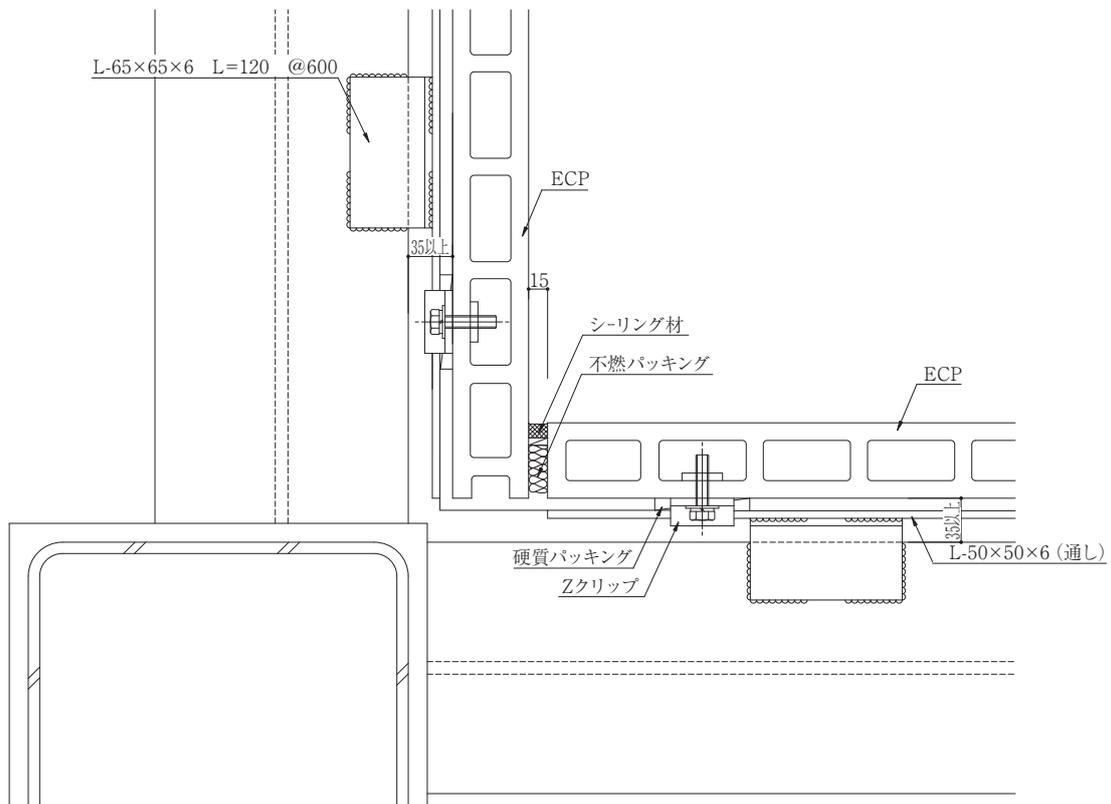
※下地鋼材を躯体鉄骨に直接溶接しない仕様の建物は、捨てプレート躯体鉄骨に工場溶接し、これに下地鋼材を溶接する。
