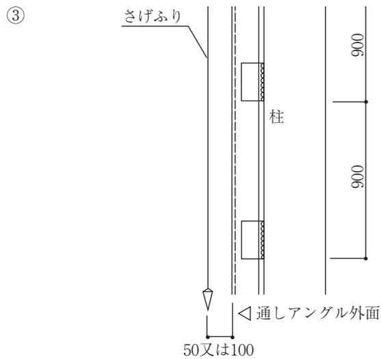
基準墨より、通しアンゲル外側に下げ振りを下ろし、精度良く万力にてブラケットに固定する。
