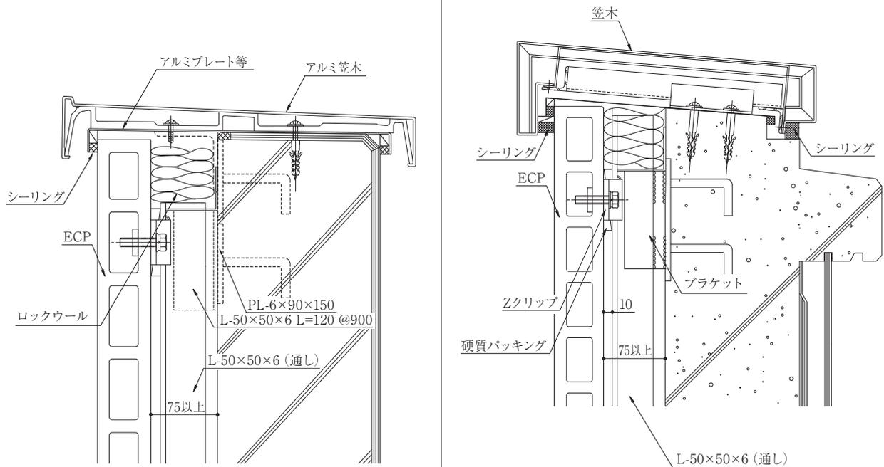
4-10 開口部垂直・水平断面詳細図
