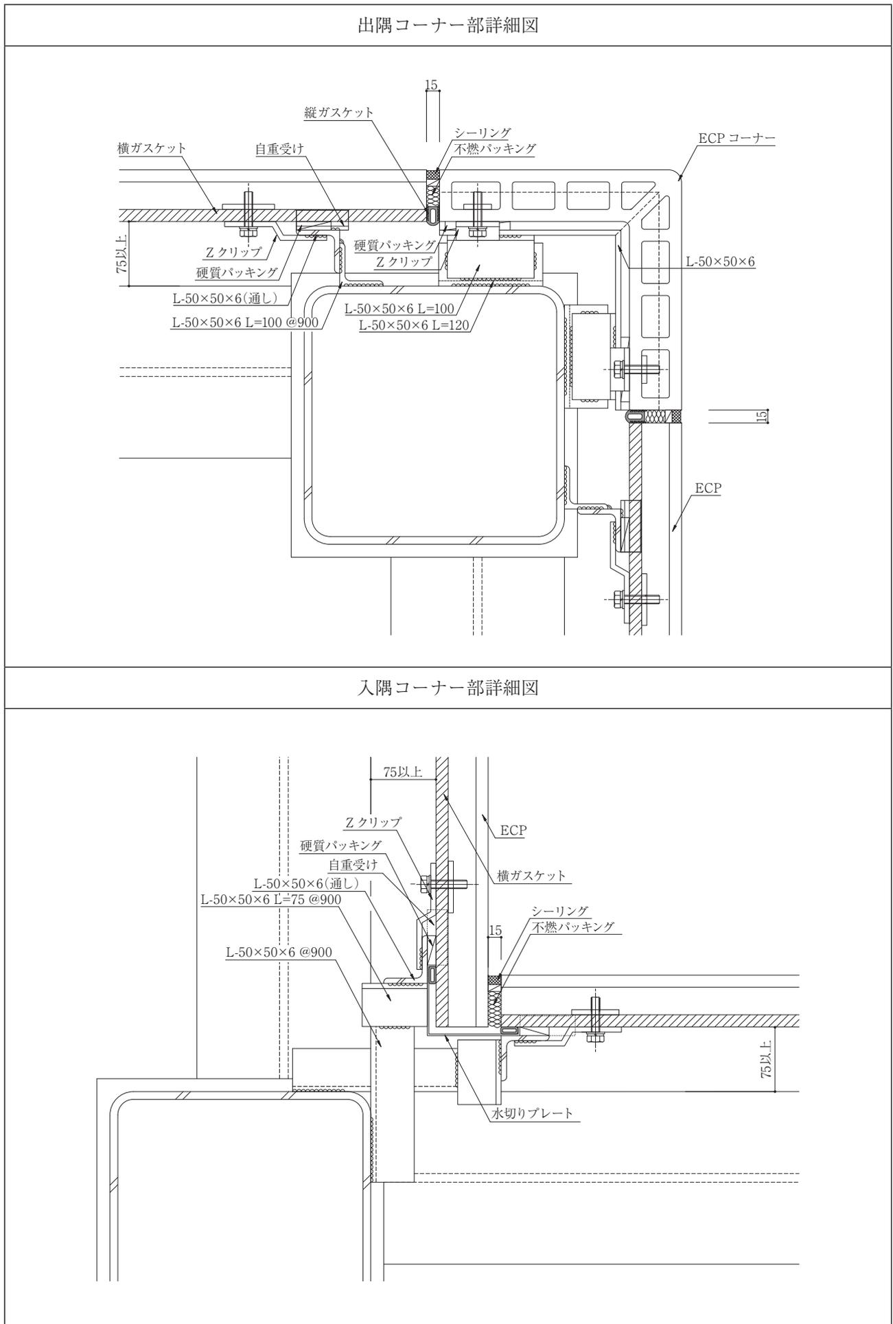
※下地鋼材を躯体鉄骨に直接溶接しない仕様の建物は、捨てプレートを躯体鉄骨に工場溶接し、これに下地鋼材を溶接する。
