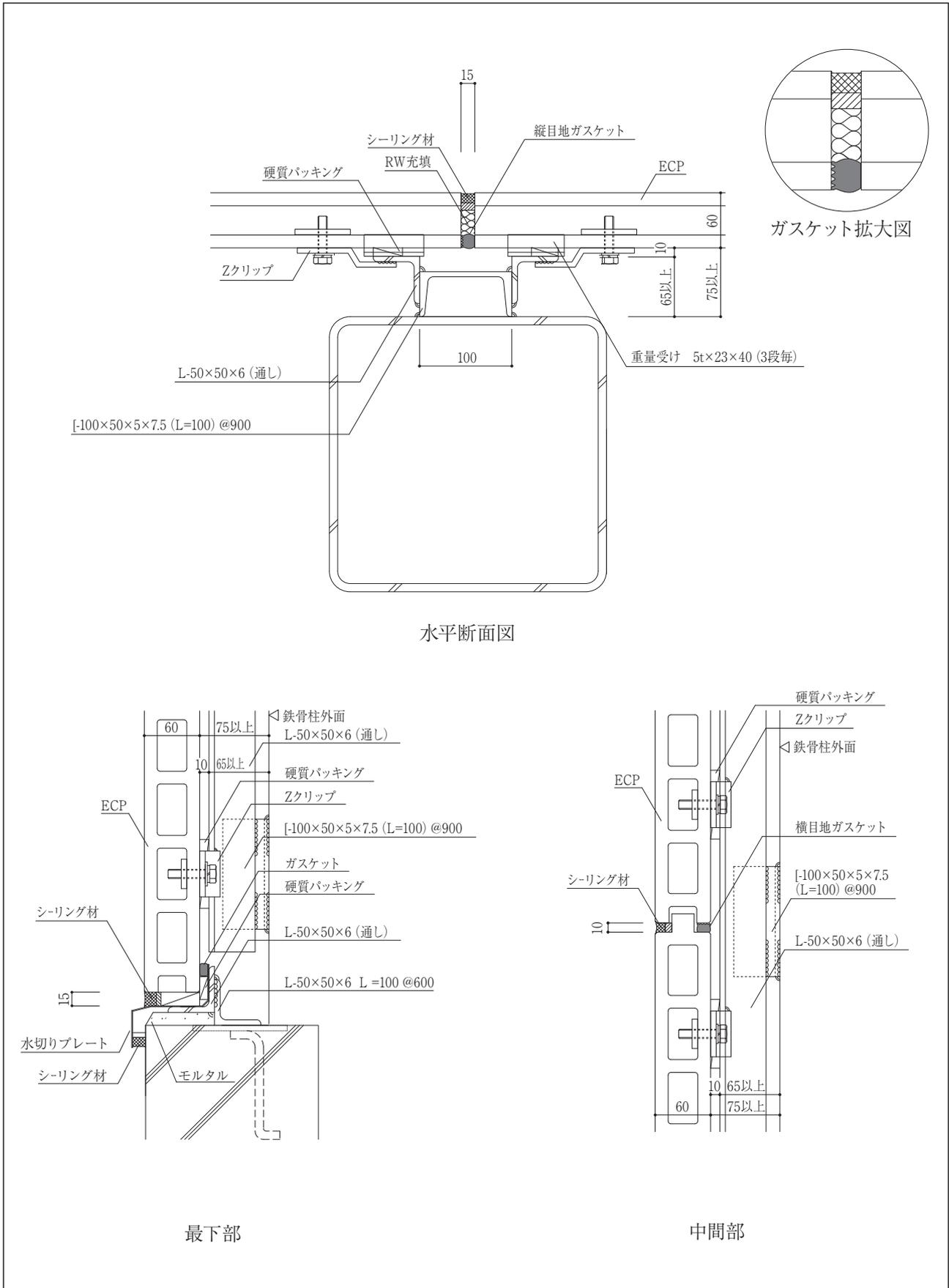
※下地鋼材を躯体鉄骨に直接溶接しない仕様の建物は、捨てプレート躯体鉄骨に工場溶接し、これに下地鋼材を溶接する。
