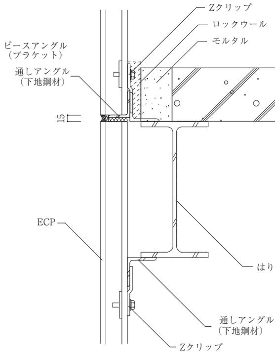
図5-3 縦張り工法中間部標準詳細図
