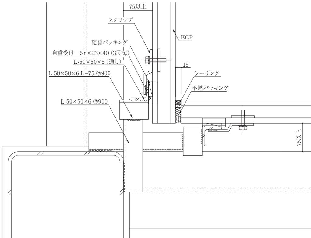
※下地鋼材を躯体鉄骨に直接溶接しない仕様の建物は、捨てプレート躯体鉄骨に工場溶接し、これに下地鋼材を溶接する。
