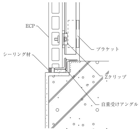
図5-6 横張り工法下部標準詳細図
