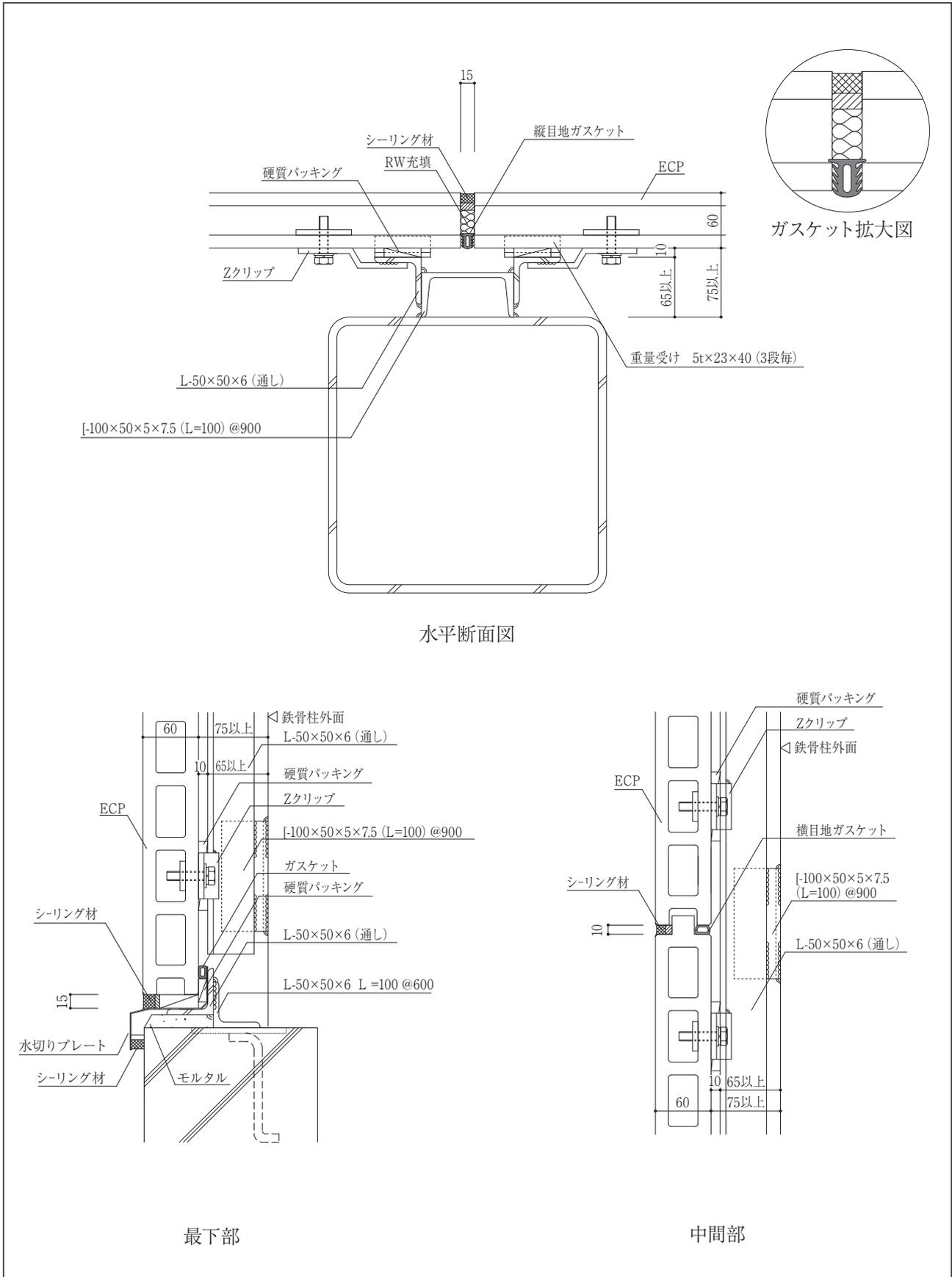
※下地鋼材を躯体鉄骨に直接溶接しない仕様の建物は、捨てプレートを躯体鉄骨に工場溶接し、これに下地鋼材を溶接する。
