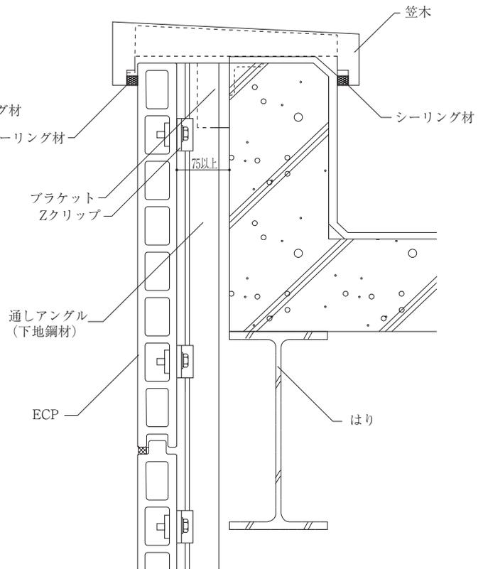
図5-8 横張り工法上部標準詳細図
