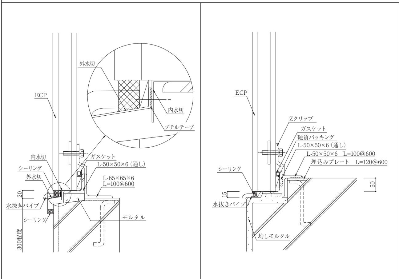
※下地鋼材を躯体鉄骨に直接溶接しない仕様の建物は、捨てプレートに躯体鉄骨に工場溶接し、これに下地鋼材を溶接する。
