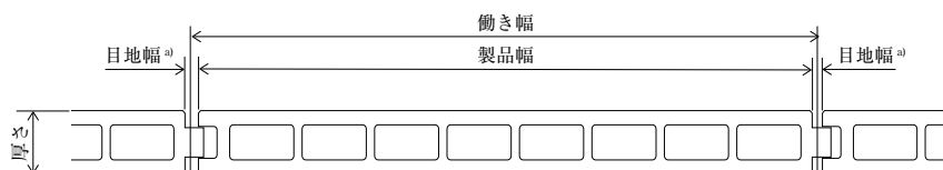
図3-2 製品幅及び厚さの例
